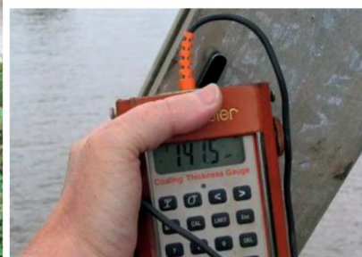
Figura 3. Grosimea stratului de zinc măsurată cu instrumentar care funcționează pe principii magnetice
