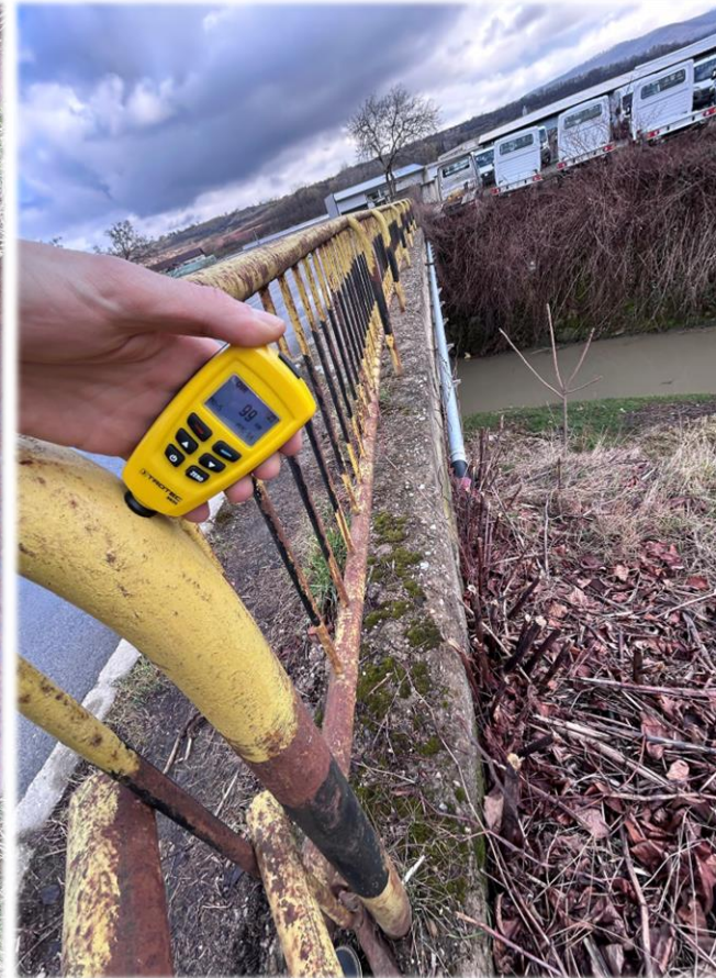
Balustradă peste Valea Zalăului cu un strat de 99 Microni de vopsea/rugină,
