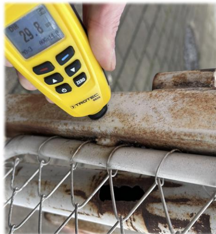
29.8 micrometri vopsea/rugină și daune mecanice cauzate de coroziune
