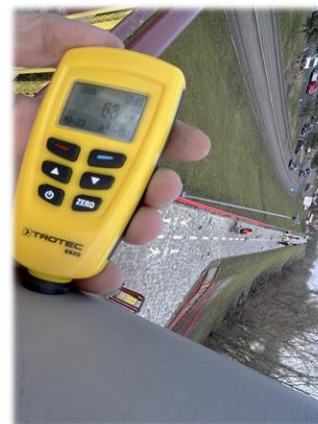
Elemente de prindere 85 microni rugină. Cel mai probabil au fost zincate electrochimic
