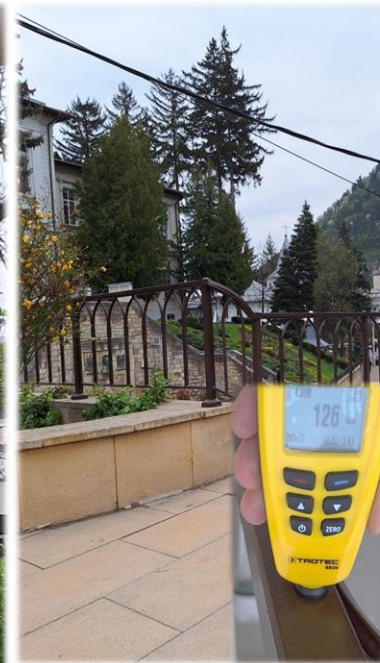
Balustradă scări 128 microni de vopsea. Pentru mediul de corozivitate C3 (urban/industrial) pentru suprafețe protejate anticoroziv prin vopsire se recomandă consultare standard SR EN ISO 12944:2018
