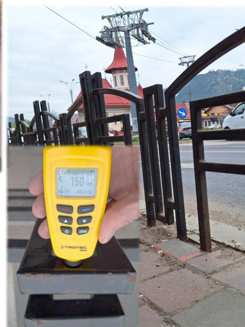
Scări afectate de coroziune, întreaga scară a clădirii este ruginită masurând peste 155 microni de rugină.
