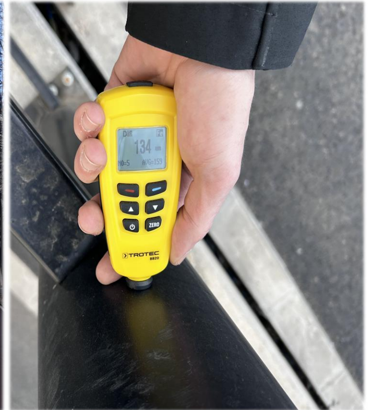
Stâlp iluminat 134 microni cu elemente de prindere ruginite
