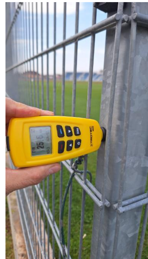
Elementele zincate termic nu sunt afectate de coroziune. Grosimea de strat de 25 de microni asigură o protecție anticorozivă de minim 12 ani fără cheltuieli de întreținere
