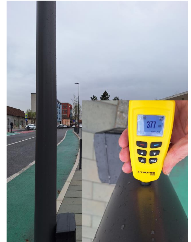
377 de microni de vopsea stâlp de iluminat, substratul posibil sa fie zinc
