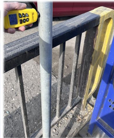
Stâlp de circulație zincat termic 37 micrometri
