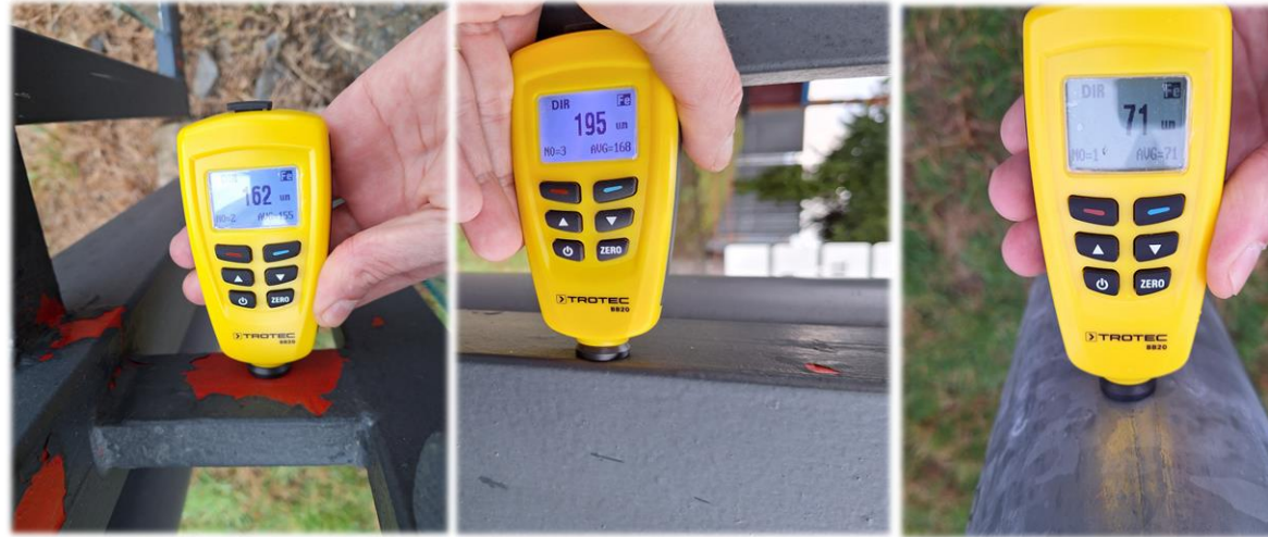
Stație de autobuz vopsită în poza din stânga este măsurat stratul suăerior iar în cea din dreapta stratul inferior
