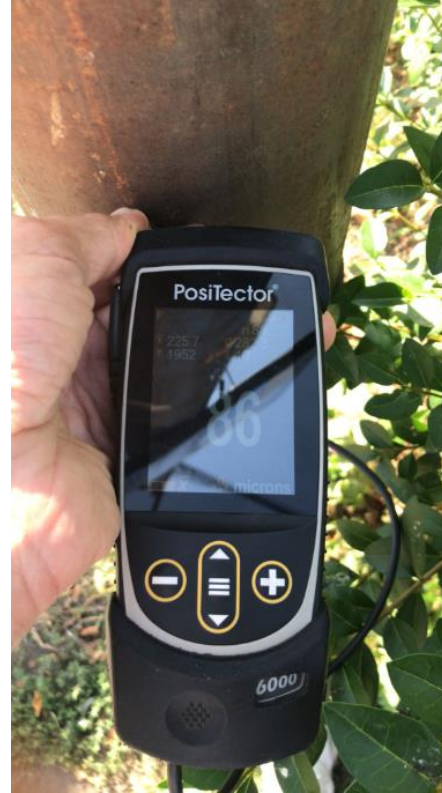
Stâlpi corodați. Exemplu de grosime de strat de coroziune de 36 de microni
