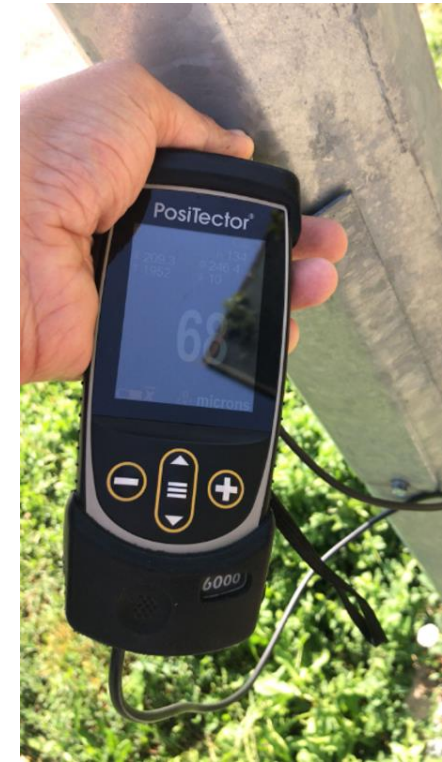
Grosimea stratului de zinc esre de 66 de microni, ceea ce presupune pentru mediul de corozivitate C3 (urban/industrial) o durata de viata de minim 35 de ani
