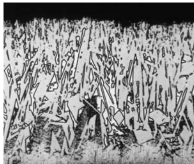
Fig. 5. Microstructura unei acoperiri groase obținută folosind oțel cu conținut ridicat de siliciu..
