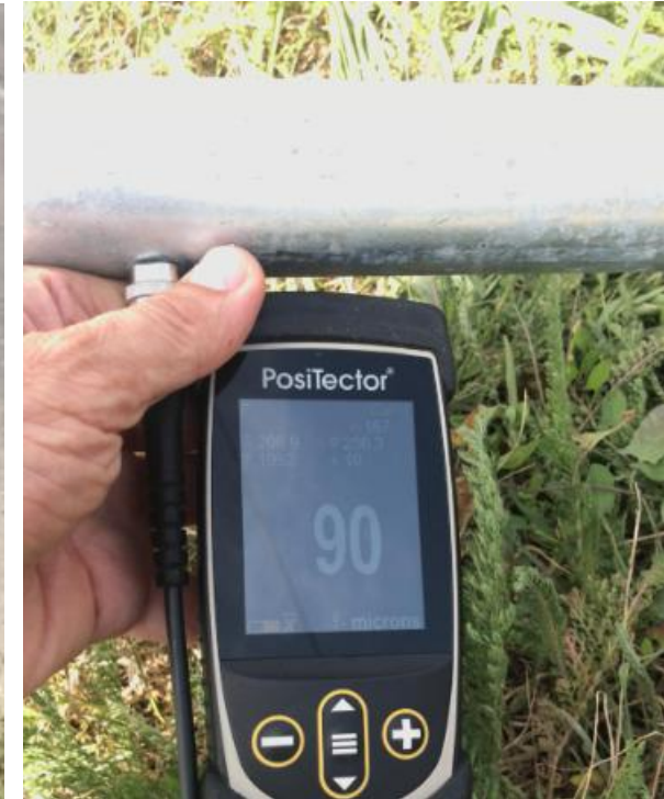
Pentru mediul de corozivitate C3 (urban/industrial) grosimea stratului de zinc de 90 de microni asigură protecție anticorozivă fără întreținere pentru minim 45 de ani
