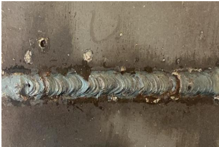
Fig. 17 Cusătura înainte de zincarea termică
