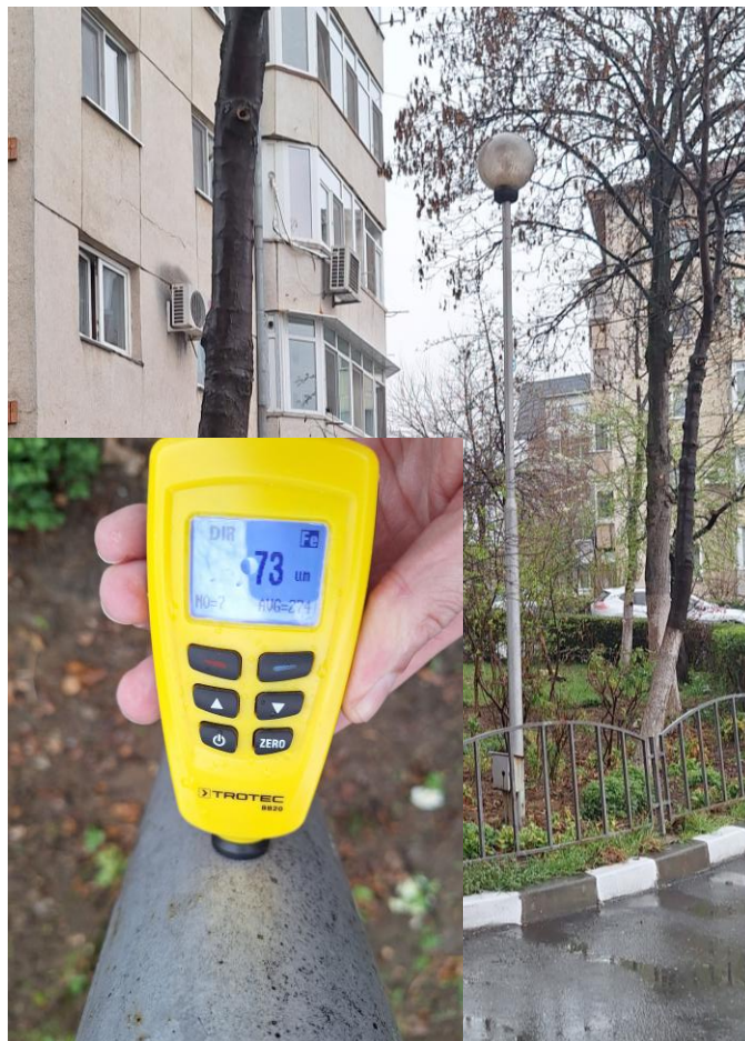
Stâlp de iluminat 73 microni vopsea/rugină. Pentru mediul de corozivitate C3 (urban/industrial) pentru suprafețe protejate anticoroziv prin vopsire se recomandă consultare standard SR EN ISO 12944:2018
