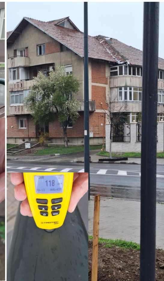
Stâlp de iluminat 118 microni vopsea. Pentru mediul de corozivitate C3 (urban/industrial) pentru suprafețe protejate anticoroziv prin vopsire se recomandă consultare standard SR EN ISO 12944:2018
