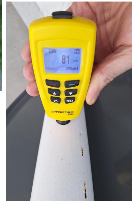
Stâlp de iluminat public zincat termic. 89 microni de zinc pentru mediul de corozivitate C3(urban/industrial) asigură protecție anticorozivă pentru minim 54 de ani fără întreținere
