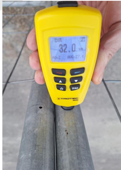
Gard împrejmuire acoperit anticoroziv prin zincare 32 microni zincare.
