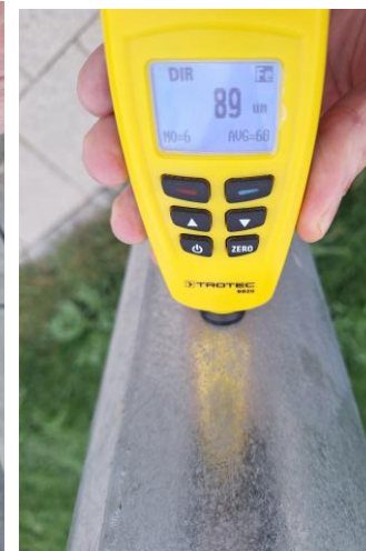
Stâlp de iluminat public zincat termic. 89 microni de zinc pentru mediul de corozivitate C3(urban/industrial) asigură protecție anticorozivă pentru minim 54 de ani fără întreținere
