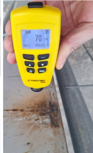
Stâlp de gard la împrejmuire acoperit anticoroziv prin zincare 32 microni zincare vopsire 70 microni de vopsea/rugină care va necesita intervenții de mentenanță și costuri de întreținere
