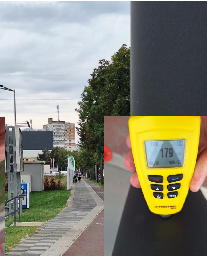
Stâlp de iluminat 179 microni. Protejat anticoroziv prin sistem duplex având la baza un strat de zinc și la suprafață un strat de vopsea. Împreună cele 2 straturi vor proteja mult mai mult împotriva coroziunii decât fiecare separat.
