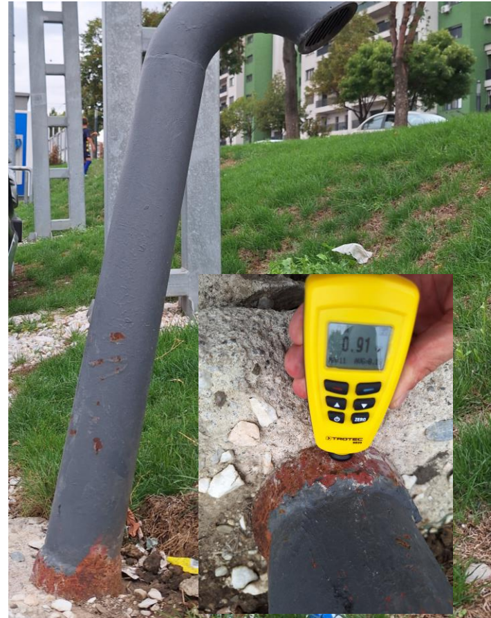
Pentru mediul de corozivitate C3 (urban/industrial) grosimea stratului de zinc de 111 microni asigură protecție anticorozivă pentru minim 56 de ani fără întreținere CEA MAI BUNĂ CALE ÎN A PREVIZIONA VIITORUL ESTE SĂ ÎL CREEZI
