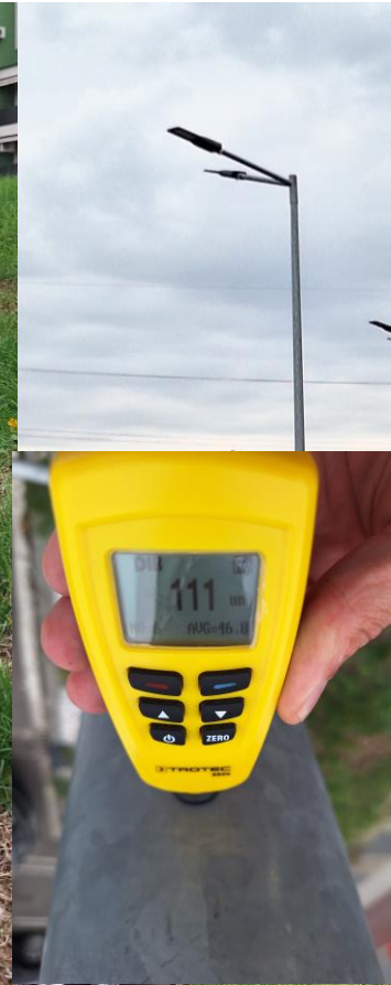
Pentru mediul de corozivitate C3 (urban/industrial) grosimea stratului de zinc de 111 microni asigură protecție anticorozivă pentru minim 56 de ani fără întreținere CEA MAI BUNĂ CALE ÎN A PREVIZIONA VIITORUL ESTE SĂ ÎL CREEZI
